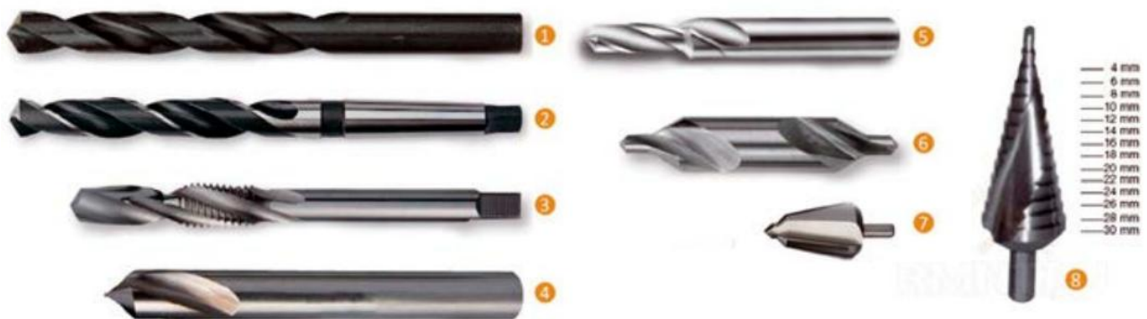
Рис. 17. Види свердел: 1 – свердло із циліндричним хвостовиком; 2 – свердло з конічним хвостовиком; 3 – комбіноване свердло для нарізування внутрішньої різьби; 4 – центрувальне свердло; 5 – ступінчасте свердло; 6 – центрувальне свердло; 7 – конічне свердло; 8 – багатоступінчасте конічне свердло
