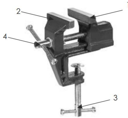
Рис. 2 Стілецьві лещата: 1 – рухома губка, 2 – нерухома губка, 3 – ніжка для закріплення, 4 - гвинт
